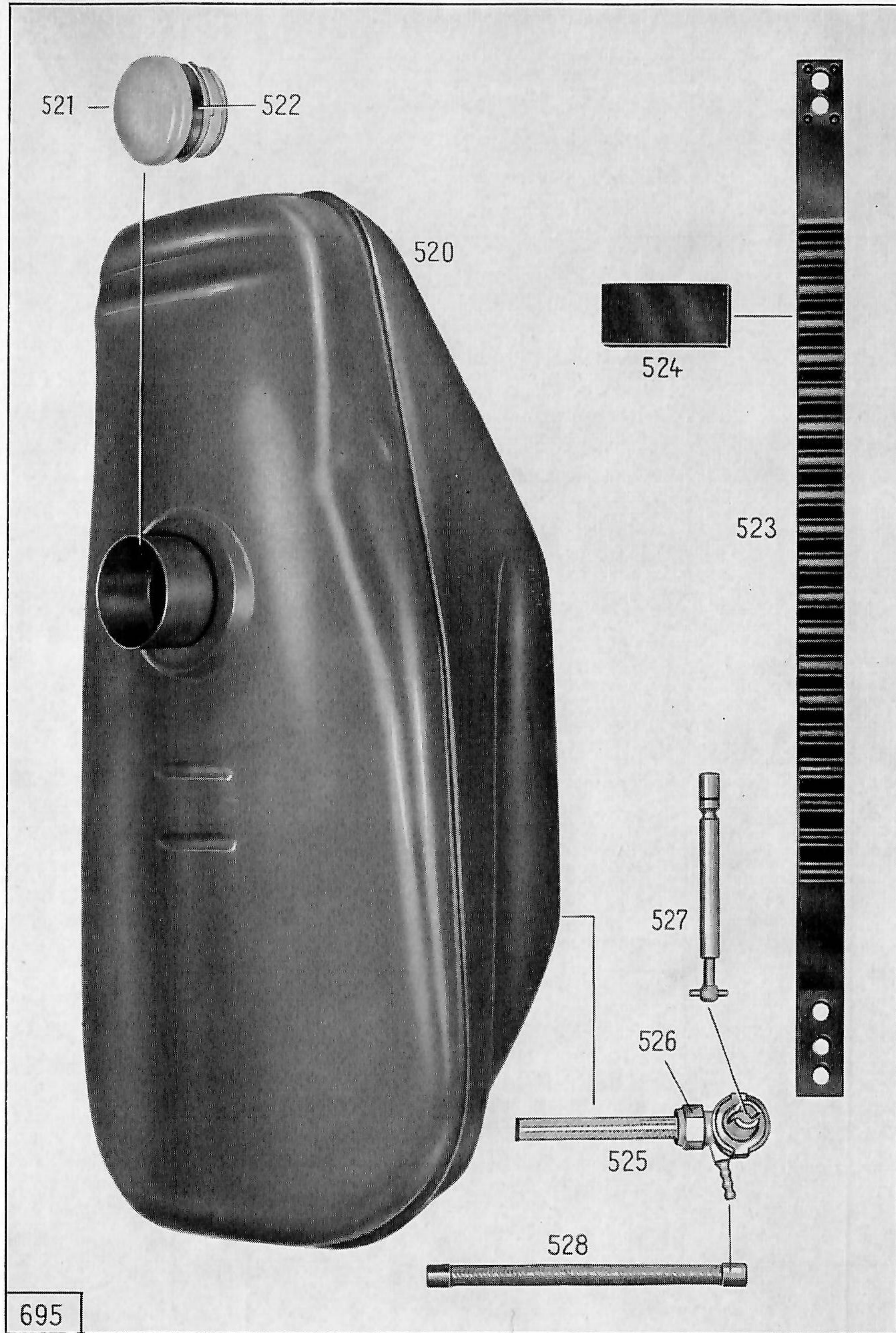
Tafel 21, Gruppe R: f) Kraftstoffbehälter und -leitungen
